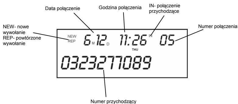
Rys.5 Opis wyświetlacza podczas przeglądania numerów przychodzących
